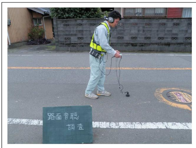
道路に埋設されている配水管の上や、消火栓などで専用機器を使って水の音を聴くことで、漏水の有無を調査します。
